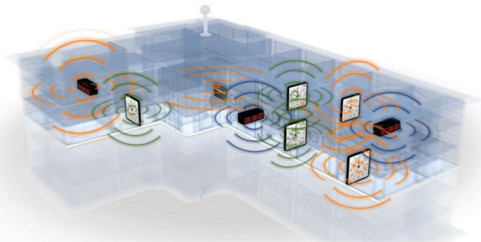
\*На рисунке представлена беспроводная система синхронизации времени Sapling. Сигнал времени передается с первичных часов на несколько подчиненных и оттуда в свою очередь на соседние часы. Таким образом образуется ячеистая сеть.
