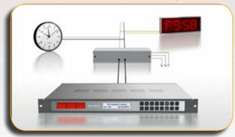
automatischen Umpolungserkennung, d.h. wenn die beiden Ausgangsdrähte rückwärts verkabelt werden, erkennt das System dies automatisch und läuft weiterhin normal. Da die Uhren mit 24 Volt versorgt werden, muss das System in den meisten Ländern nicht von einem zertifizierten Elektriker installiert werden. Dadurch werden die Installationskosten reduziert, da dieses System von jedem technischen Personal
