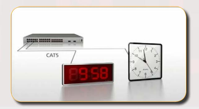
Das IP-System wird sowohl mit Analog- als auch Digitaluhren angeboten. Es nutzt die Power-over-Ethernet-Infrastruktur, die Leistung und Daten über dasselbe CAT5-Kabel liefert. Die PoE-Uhren werden in der Regel mit einem PoE(Power over Ethernet)-Switch oder einem PoE-Injektor angetrieben. Einer der größten Vorteile dieses Systems ist, dass keine Hauptuhr erforderlich ist, da jede Uhr die Zeitdaten direkt von der NTP/SNTP-Zeitquelle erhalten kann.
