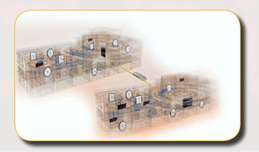
TalkBack Technology ist das fortschrittlichste Drahtlos-Zeitsystem der Branche. Das normale Drahtlossystem umfasst eine Hauptuhr und Nebenuhren. Die Hauptuhr teilt den Nebenuhren einfach die Uhrzeit mit. Mit der TalkBack Technology von Sapling sind die Nebenuhren in der Lage, wertvolle Statusinformationen an die Hauptuhr zu leiten.
