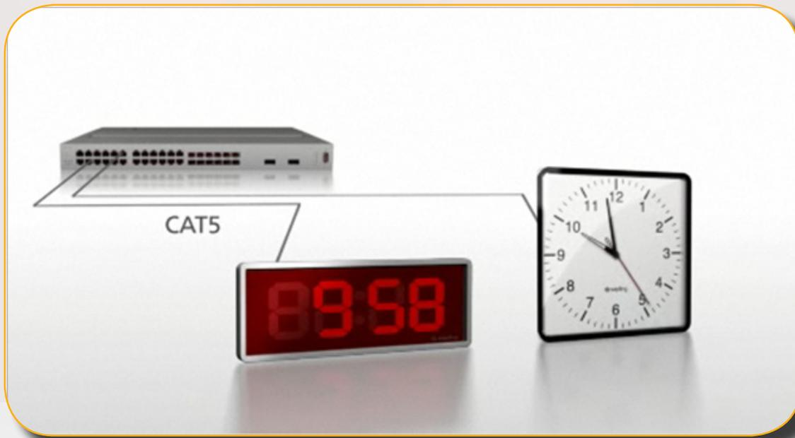
El Sistema IP se ofrece para los relojes analógicos y digitales. Utiliza una infraestructura de alimentación a través de Ethernet (PoE) que proporciona energía y datos a través del mismo cable CAT5 o CAT6. Los relojes PoE normalmente funcionan con un interruptor PoE (Power over Ethernet) o con un inyector PoE. Uno de los mayores beneficios de este sistema es que no necesita ningún reloj maestro porque cada reloj puede recibir los datos de la hora directamente desde la fuente horaria NTP / SNTP.
