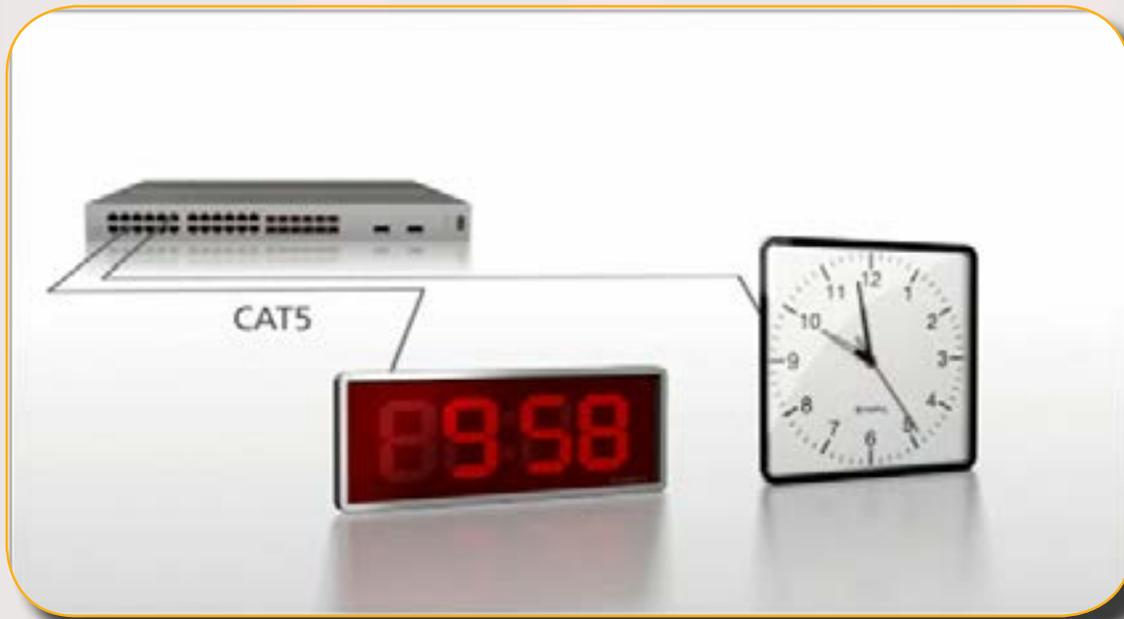
O sistema IP está disponível em relógios analógicos e digitais. Ele usa a infraestrutura Power over Ethernet, que transmite energia e dados através do mesmo cabo CAT5 ou CAT6. Os relógios PoE geralmente são alimentados por um interruptor PoE (Power over Ethernet) ou um injetor PoE. Uma das maiores vantagens desse sistema é que não há necessidade de um relógio principal, já que cada relógio recebe o horário diretamente da origem do horário NTP/SNTP.
