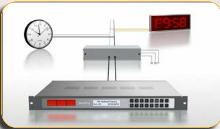
O sistema de comunicação digital por dois fios é confiável e muito fácil de instalar: apenas dois fios paralelos ligam cada relógio. O sistema tem a função de detecção automática de polaridade reversa, o que significa que, se os dois fios de saída forem ligados ao contrário, o sistema automaticamente identificará isso e continuará a funcionar normalmente.
