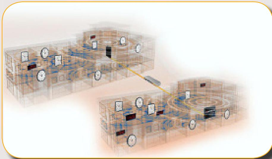
Le système TalkBack est le système d'horloges synchronisées sans fil le plus avancé dans l'industrie. Le système sans fil traditionnel comprend une horloge maîtresse et des horloges secondaires. L'horloge maîtresse indique seulement l'heure. Avec le système TalkBack de Sapling, les horloges secondaires sont capables de communiquer des informations utiles à l'horloge maîtresse.
